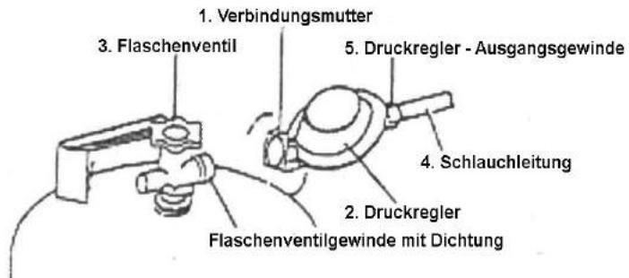
Vor der Inbetriebnahme des Gasofens mit einem Gaslecksuchspray überprüfen, dass keine Undichtigkeit vorliegt und dass kein Gas austritt.
