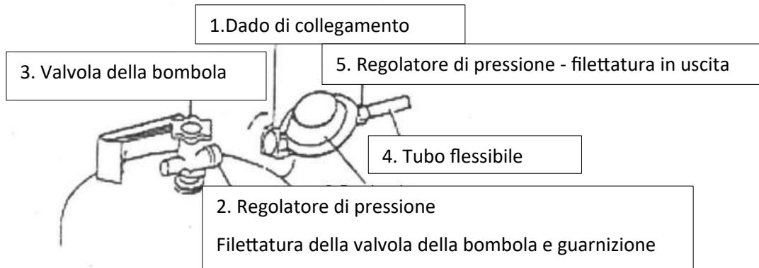
Prima di utilizzare la stufa, controllare tramite uno spray rivelatore di perdite di gas che non siano presenti perdite.
